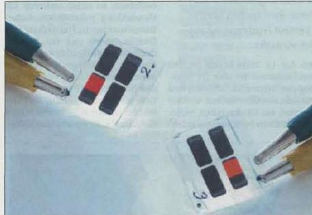
Flüssigprozessierte SILEDs: Größenänderungen der Silizium-Nanokristalle helfen, die Farbe des ausgesandten Lichts zu variieren. Bild: F. Maier-Flaig, KIT/LTI
